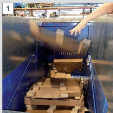
Anyagbetöltés a BaleTainer® garat-részébe előzúzás nélkül!
