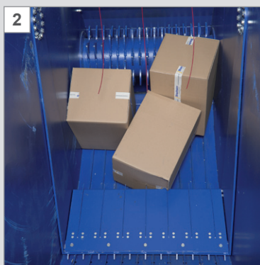
Az inga szerű mozgást végző betöltést segítő eszköz (pendulum) juttatja az anyagot a rotorhoz.
