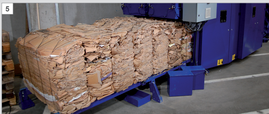
Az elkészült bálák az összekötözést követően automatikusan távoznak a gépből.
